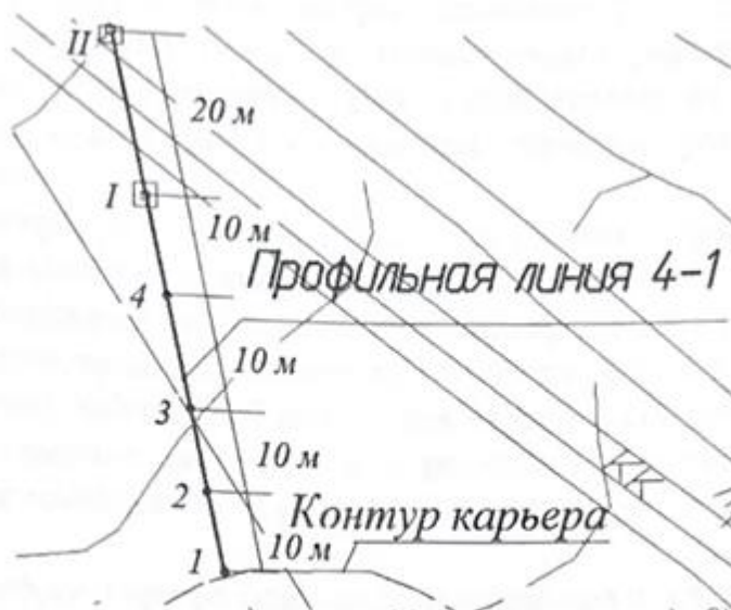
Сурет 22 – Жердегі бақылау станциясының профильдік сызықтар схемасы
